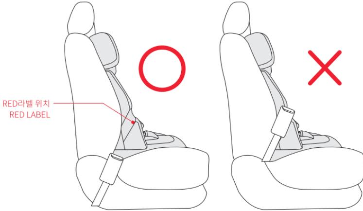
차량용 2점식 벨트 체결부위 시트 버클 높이가 카시트에 부착된 RED라벨 보다 낮을 경우 장착 가능하며, 높을 경우 장착 불가능 합니다.
